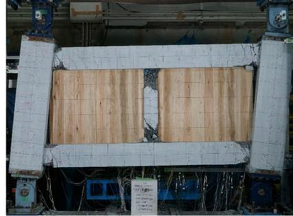
図6 試験体2CLT-60 最終破壊状況
