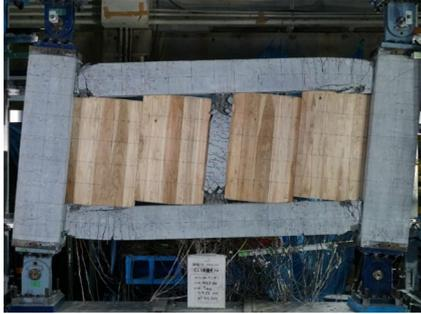
図5 試験体4CLT-60 最終破壊状況
